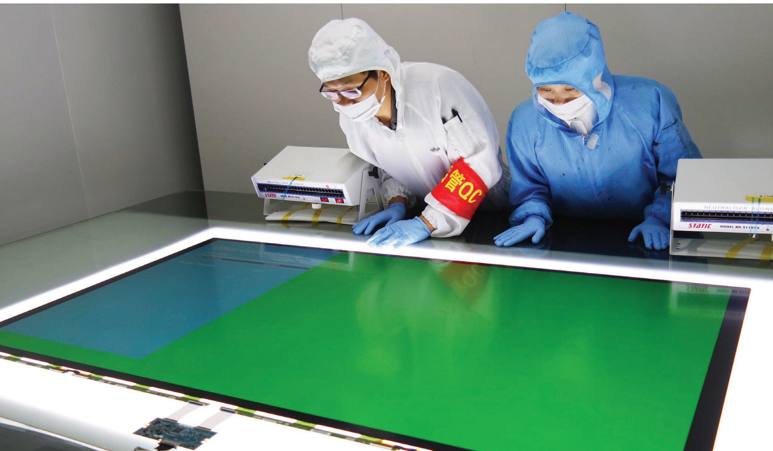
Prüfung eines optisch gebondeten 86" Displays
