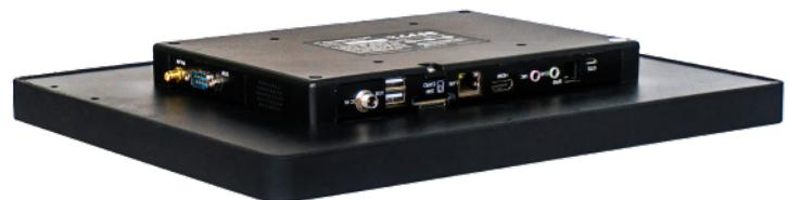
Die Embedded Touch PCs von faytech verfügen über ein vorinstalliertes Android 6 Betriebssystem und sind mit W-LAN ausgestattet. Das Gerät ist in der Front IP65 geschützt und verfügt über ein kapazitives 10-Finger-Multitouchpanel. Die PCs zwischen 13,3" und 27" werden mit einem eigenen Standfuß und VESA 100 Bohrungen auf der Rückseite geliefert, um eine einfache Montage zu ermöglichen.
