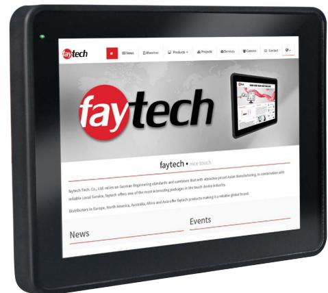
Die Embedded Touch PCs von faytech verfügen über ein vorinstalliertes Android 6 Betriebssystem und sind mit W-LAN ausgestattet. Das Gerät ist in der Front IP65 geschützt und verfügt über ein kapazitives 10-Finger-Multitouchpanel. Die PCs zwischen 13,3" und 27" werden mit einem eigenen Standfuß und VESA 100 Bohrungen auf der Rückseite geliefert, um eine einfache Montage zu ermöglichen.
