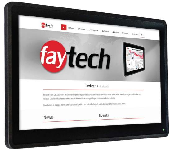
faytech's kapazitive PC-Serie hebt sich durch die lüfterlose Betriebsweise, das IP65 Front Design, einer hohen Zuverlässigkeit und der edlen Verarbeitung von der Konkurrenz ab.
