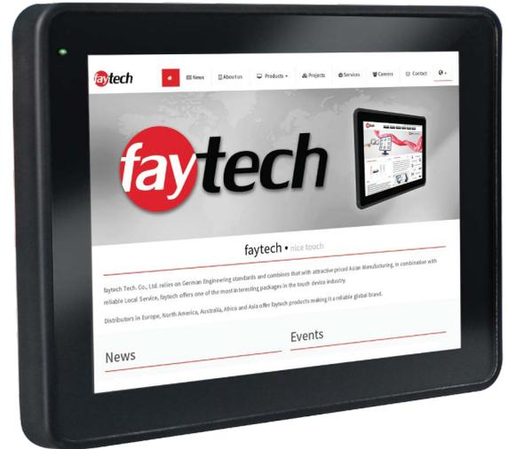
faytech's kapazitive PC-Serie hebt sich durch die lüfterlose Betriebsweise, das IP65 Front Design, einer hohen Zuverlässigkeit und der edlen Verarbeitung von der Konkurrenz ab.
