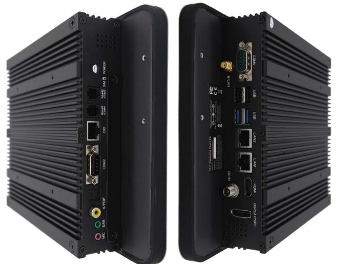
faytech's kapazitive PC-Serie hebt sich durch die lüfterlose Betriebsweise, das IP65 Front Design, einer hohen Zuverlässigkeit und der edlen Verarbeitung von der Konkurrenz ab.
