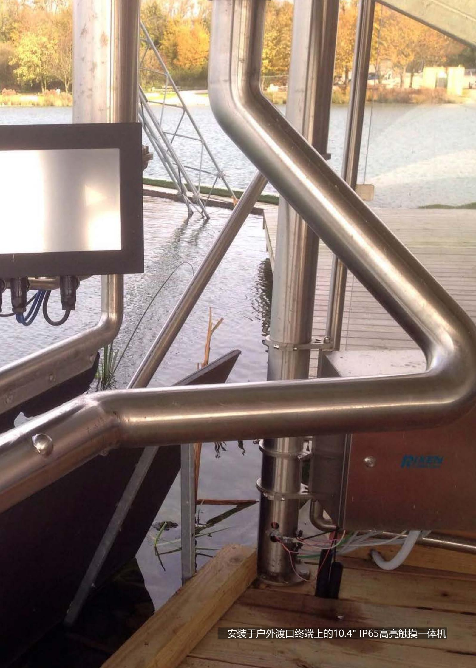
安装于户外渡口终端上的10.4" IP65高亮触摸一体机
