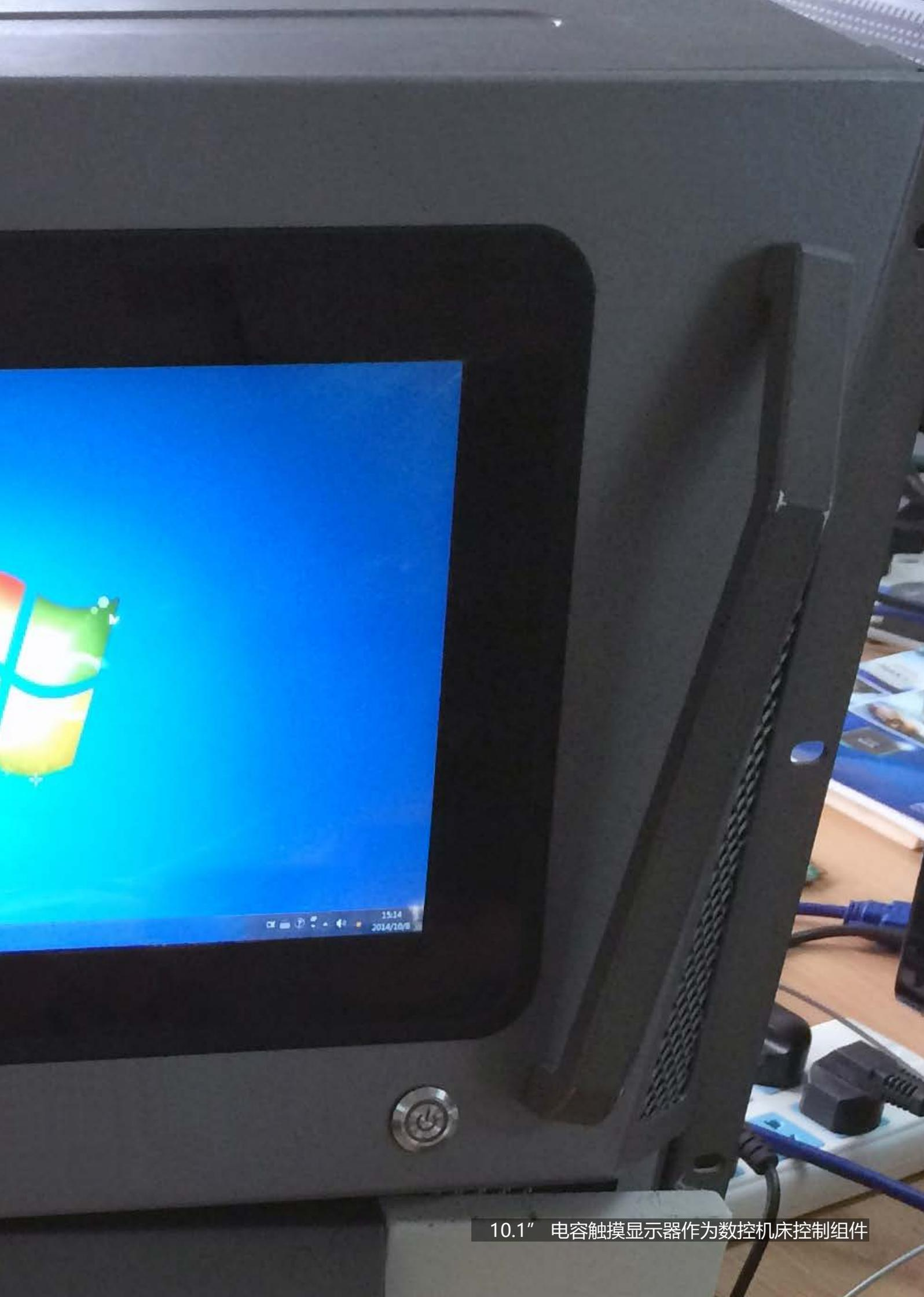
10.1" 电容触摸显示器作为数控机床控制组件
